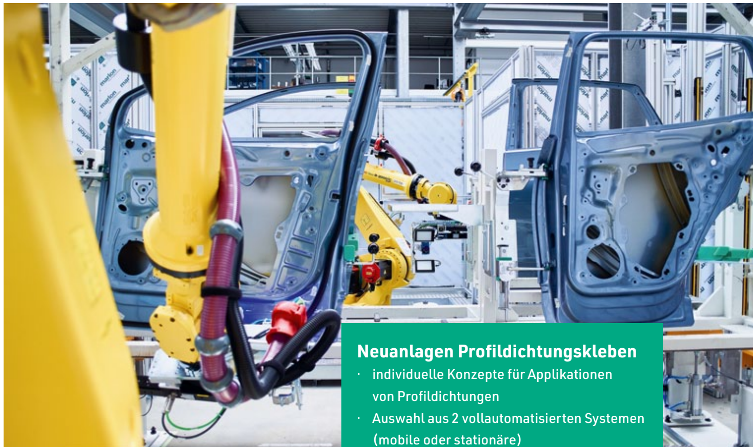
Mobile Variante mit verfahrendem Transporthänge
