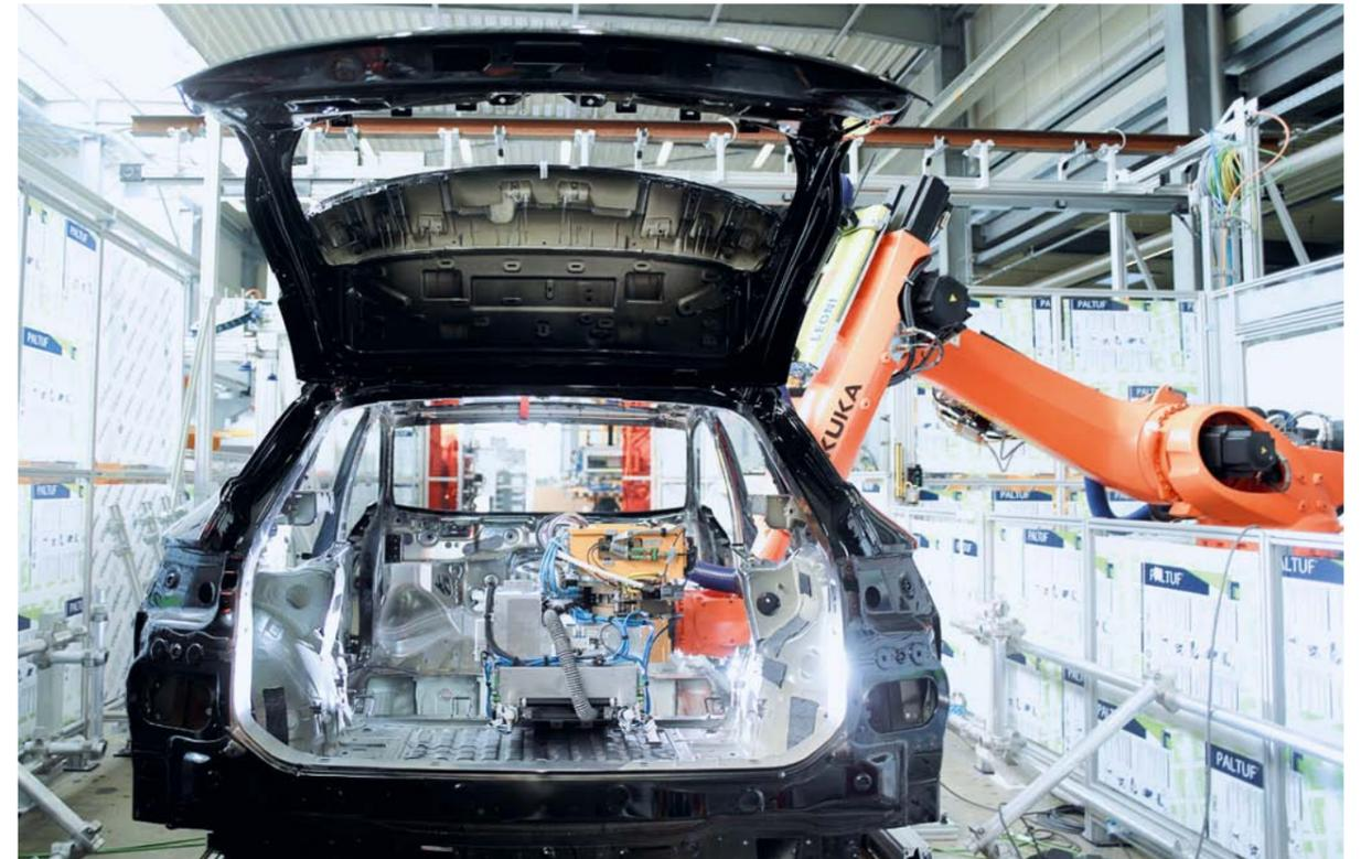
In Kooperation mit Trotec Laser, dem Spezialisten für Laserapplikationen, bietet ATN auch eine automatisierte Lösung zur Prägung der Fahrzeugidentifikationsnummer mittels Laser. Die Lasergravuren ermöglichen eine berührungsfreie Gravur und bieten eine Alternative unter anderem zum Ritzprägeverfahren. Flexible Materialauswahl, kurze Zykluszeiten und sichere Arbeitsumgebungen durch die robusten und kompakten Integrationslaser erhöhen so auch die Effizienz der Applikation.
