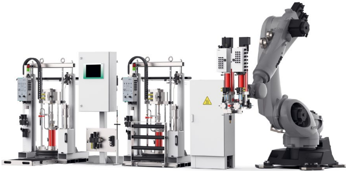
Hotbutyl-Dualdosiersystem für Abdichtungen mit Verarbeitungstemperaturen bis 180 °C
