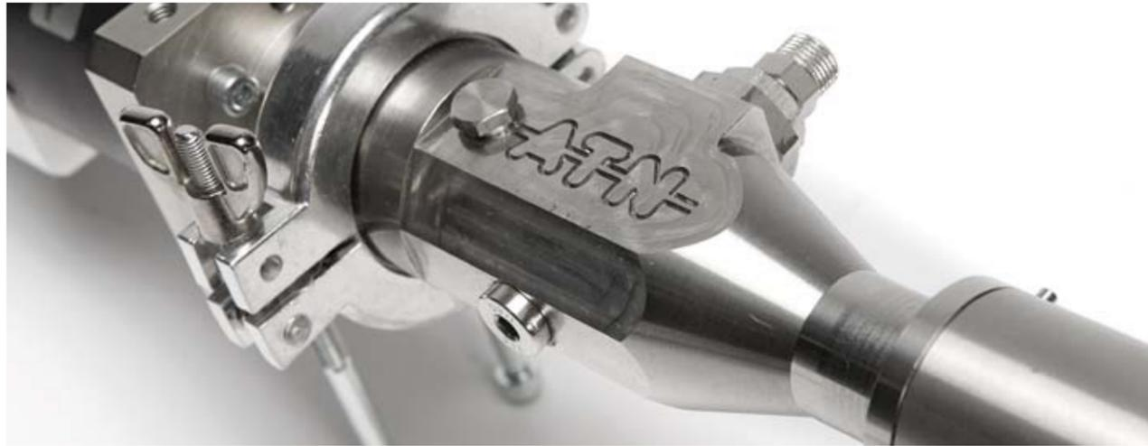
Das Dispenser-System ESP ermöglicht unabhängig von Viskositätschwankungen eine schonende und pulsationsfreie Endlosförderung des Materials in variable Förderrichtung (Materialförderung oder Dosierung). Die exakt definierte Dosierung erfolgt mit einer Wiederholgenauigkeit von über 99% und verhindert eine Materialanhäufung bei Start und Stopp von Punkt- oder Raupendosierungen. Ein Nachtropfen und Fadenziehen des Materials wird durch den steuerbaren Rückzug verhindert.
