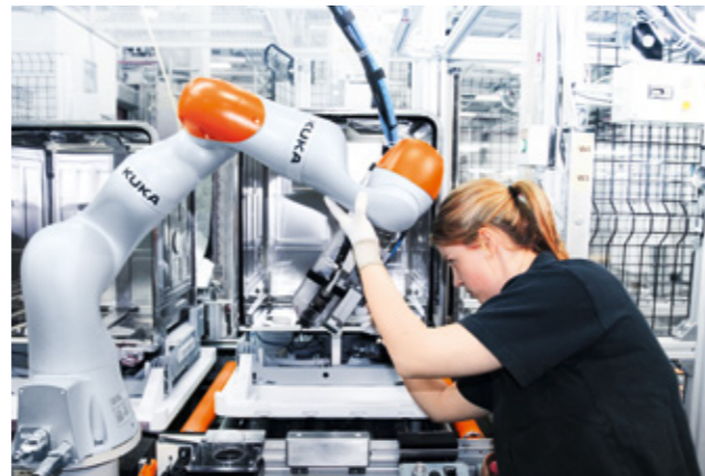
Mit dem sensitiven Kollegen effizient Spülmaschinen verschrauben.
